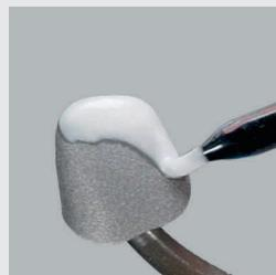
Равномерно нанести на поверхность каркаса стеклянным инструментом, не допуская полос.
